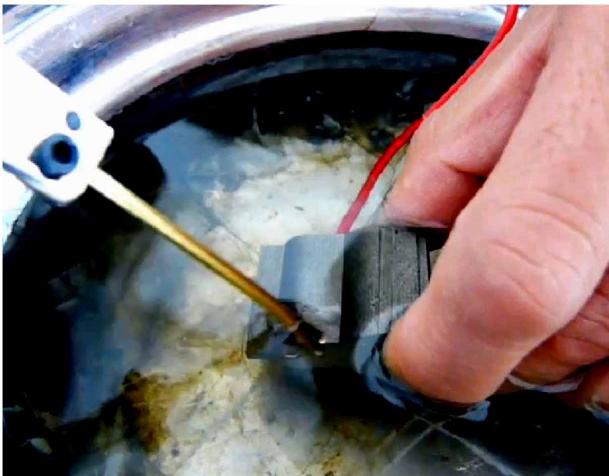
Opracování povrchu funkcí ERODE ( za přítomnosti kapaliny je funkce velmi účinná a rychlá)
